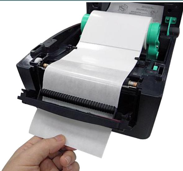
4. Öffnen Sie die Abdeckung des Abziehmoduls. Führen Sie das Tragband durch den Schlitz der Abziehabdeckung.
