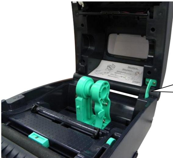
2. Eine Sperre am hinteren Teil der Abdeckung greift in das Unterteil und hält die Abdeckung offen.
