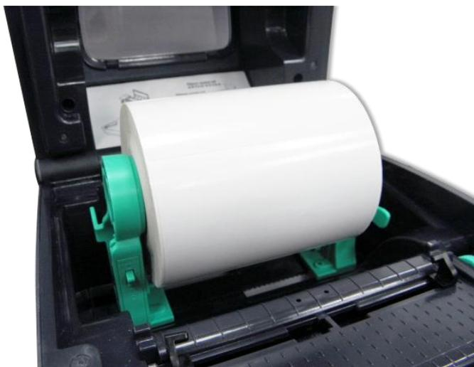
3. Legen Sie die Rolle zwischen die Halter, lassen Sie die beiden Lager in den Rollenkern greifen.
