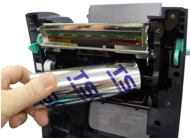
3. Setzen Sie das Farbband mit der rechten Seite zuerst in die Halterung ein. Setzen Sie das Band auf der linken Seite in die Zähne ein.
