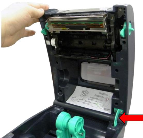
3. Zum Schließen halten Sie die obere Abdeckung nach hinten geneigt und lösen die Sperre vom Unterteil. Schließen Sie die obere Abdeckung sanft.
