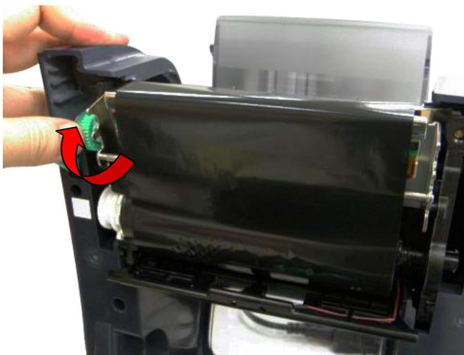
6. Drehen Sie das Aufwickelzahnrad, bis der Kunststoffvorlauf fest aufgewickelt ist und der schwarze Teil des Bandes am Druckkopf anliegt.
